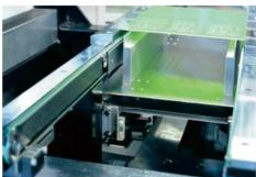
>可编程弹性侧夹和磁性支撑装置。
