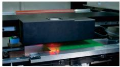
▶四路光源可调,光源强度可调,光照均匀,采集图像更趋完美; 可很好的识别(包括凹凸不平的Mark点),适应镀锡,镀铜, 镀金,喷锡,FPC等各类型不同颜色的PCB。
