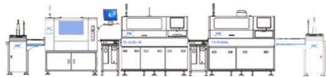
· 上板机 · 轻触开关插件机 · 接驳台 · 卧式跳线插件机 · 接驳台 · 立式插件机 · 收板机 · PCB loader · Touch Switch Insertion Machine · Conveyor · Axial jumper Insertion Machine · Conveyor · Radial Insertion Machine · PCB Unloader
