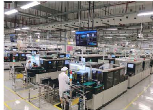
· 上板机 · 轻触开关插件机 · 接驳台 · 卧式跳线插件机 · 接驳台 · 立式插件机 · 收板机 · PCB loader · Touch Switch Insertion Machine · Conveyor · Axial jumper Insertion Machine · Conveyor · Radial Insertion Machine · PCB Unloader
